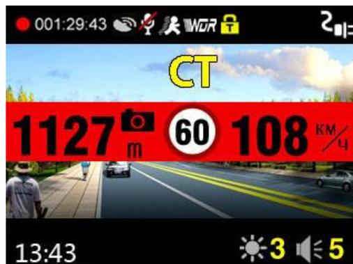
Скорость автомобиля больше установленного
